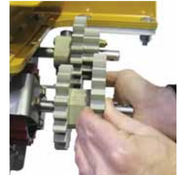
**2** Cambio di velocità ad ingranaggi
