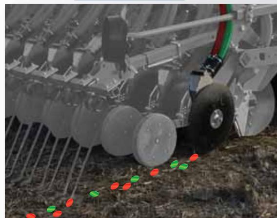
Il sistema di distribuzione "BITUBE" permette di posizionare nella stessa linea in maniera indipendente e variabile dall'operatore seme e concime.
